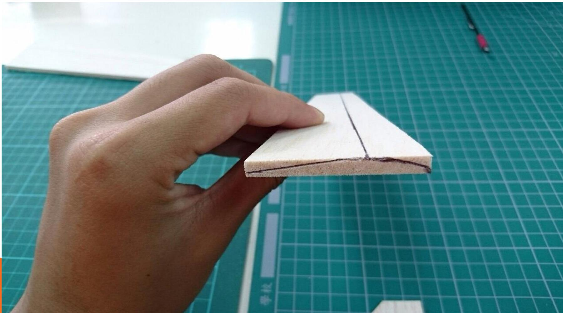
以美工刀先慢慢削機翼(也可直接使用粗砂紙)
